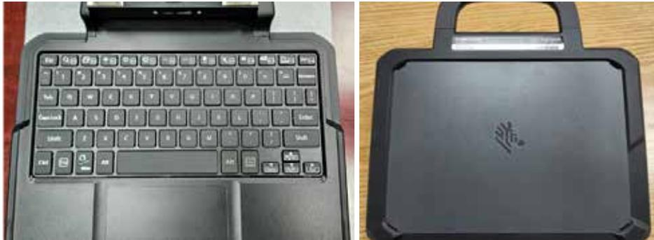
專為極端環境設計，具備減重與強固的結構設計，2023 年進行產品升級，除了重量減輕 20%，並經過嚴格的耐久測試，放置於 -10°C、25°C 及 60°C 三種溫度環境下兩小時後，進行六面 1.2 公尺的落摔測試，結構依然完好且功能無異常。此外，S9859 符合 IP65 防塵防水等級規格，確保其在各種工業環境中提供穩定且可靠的性能。
