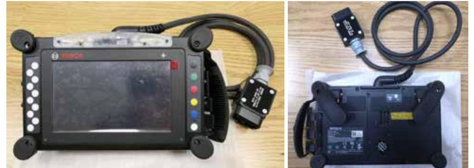
2023 年進行 S0688 升級設變，強化了資源節省及使用便利性，線纜設計由固定線長的 DLC CABLE 改為可拆卸型式 Detachable，增加使用的靈活性。散熱性能方面，S0688 採用散熱風扇蓋設計，增加開孔率，使散熱效果顯著提升，從而節省電力。在硬體和韌體的變更上，S0688 進一步提高了效能與省電效果。升級後的硬體採用新款的 SOC 與新 EC 設計，並增加 DRAM 容量，使整體效率提升達 230%。韌體的優化則降低待機能耗，第一代的待機耗電從 14-10mA 降至第二代的 6mA，進一步實現節能目標。
